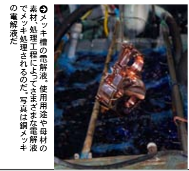
⑥メッキには電気メッキと無電解メッキ、真空蒸着の方法がある。バイクパーツの場合、密着の問題などで電気メッキがいいそう。メッキ金属(+)と被メッキ金属板(-)の間に電流を流すことによりメッキを付着させる。メッキ金属棒中の金属イオンが被メッキ物に移動して表面に付着させるのだ
